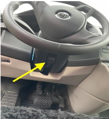
1. Lenkrad lösen und ganz nach nach oben und rein stossen
