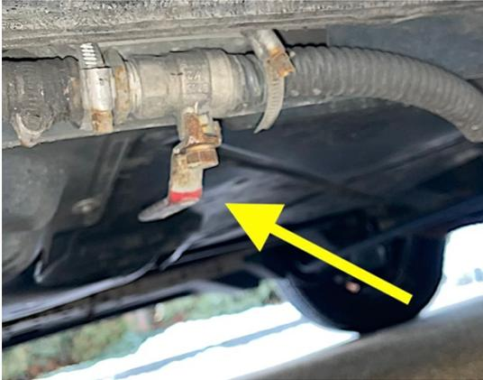
Der Abwassertank befindet sich hinter dem Kühlschrankschrank und fasst ca. 8 Liter. Der Abflusshahn sollte geschlossen sein und nur bei Entsorgungsstationen oder versickerbarem Untergrund geöffnet werden.
