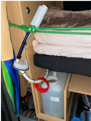
Die Pumpe Lauft mit 12 V ber die Bordbatterie.
