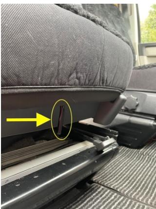
5. Den dünnen Hebel vorne unter dem Sitz nach rechts Richtung Beifahrer drücken und gleichzeitig Sitz Richtung Beifahrer umdrehen.
