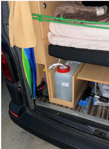
Zwei Frisch-Wasserkanister je 16 Liter befinden sich hinten links und können zur Befüllung und Reinigung herausgenommen werden.
