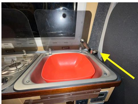
Der Wasserhahn ist schwenkbar aber nur sehr begrenzt drehbar. Ist Luft in der Leitung kann es etwas dauern, bis Wasser fliest. Die Schssel hilft beim Wassersparen. Kann allenfalls auch direkt nach draussen entleert werden!
